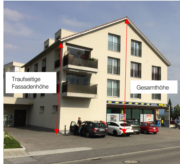
Abb. 2: Beispiel Gesamt- und Fassadenhöhe
